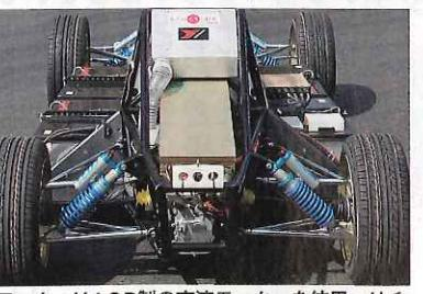
モーターはACP製の交流モーターを使用。リチウムイオンバッテリーとの組み合わせは現状では最も強のウェポンといえる
