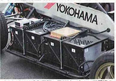
バッテリーは昨年同様、信頼性の高い三洋電機のリチウムイオンバッテリーを搭載
